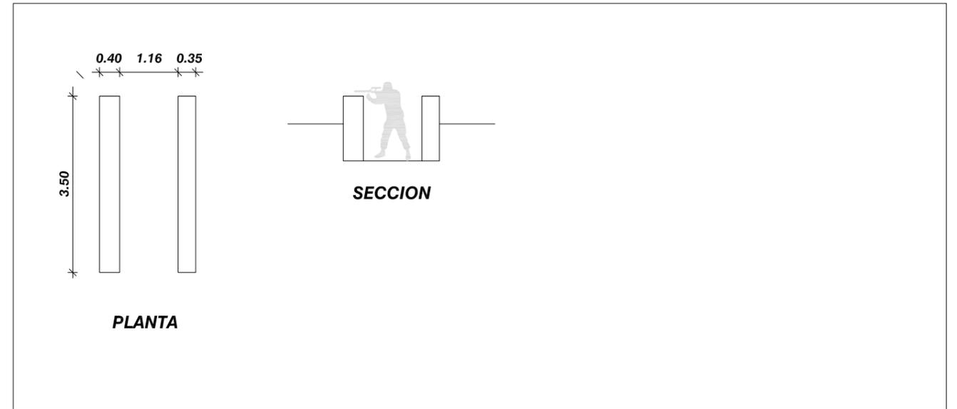
ESQUEMA DE TRINCHERAS
